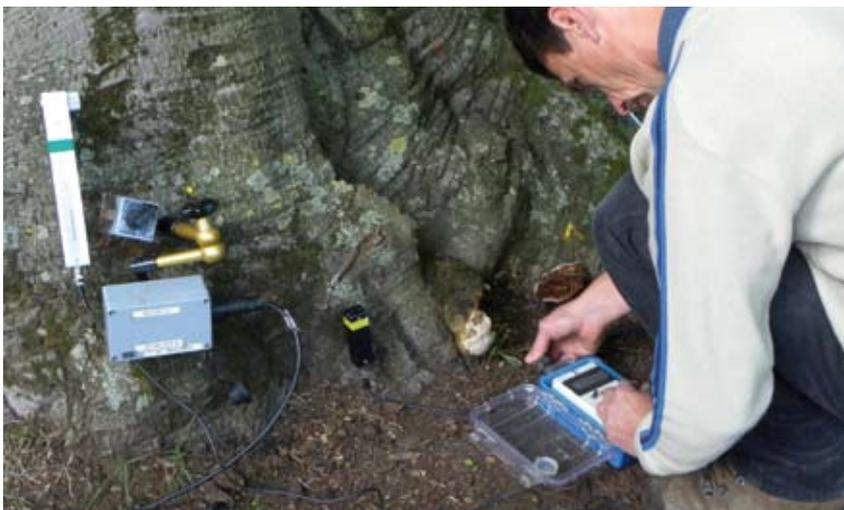
Installation de l'inclinomètre par Vincent Dellus avant le test de traction
