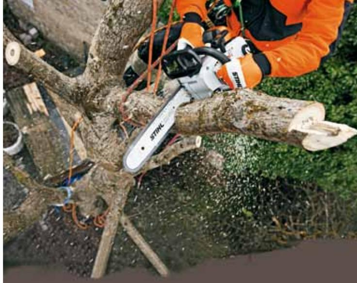
Le poids de la MS 201 T est réduit (3,7 kg réservoirs vides), tout comme le niveau des vibrations dans les poignées. D'autres détails bien réfléchis améliorent encore la vie de l'élagueur, tels que l'écrou imperdable du couvercle de pignon, ou le protège-guide qui se clipse sur le carter. Les bouchons quart de tour ont des repères de fermeture pour un usage plus rapide.
