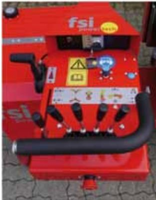
Il arrive parfois que l'opérateur se déplace afin d'apposer un regard sur le travail en cours, cet équipement permettra une mise en sécurité totale de l'opérateur et de son environnement. La remise en route du disque opérant une fois l'opérateur à son poste et impulsion sur un bouton de mise en rotation du disque.
